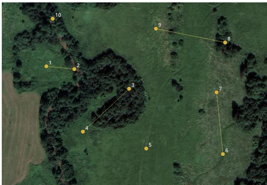
Рис.2. Пример нанесения опорных точек и линий профилирования
