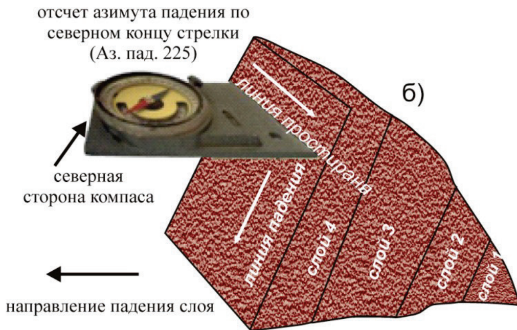
Рис. 30. Измерение элементов залегания: а – угол падения; б – азимут падения
